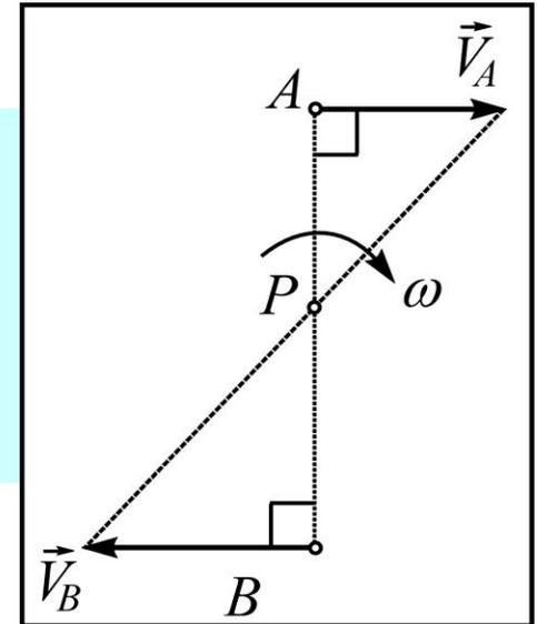
U dole prikazanom specijalnom slučaju kada su brzine paralelne i samim tim potezi takođe paralelni (bez poklapanja) trenutni pol je u beskonačnosti i važi da je ugaona brzina tela, u datom trenutku, jednaka nuli
