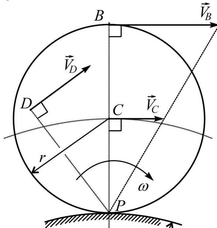
Bilo da se disk (točak, obruč) kotrlja bez klizanja po pravolinijskoj ili krivolinijskoj nepokretnoj podlozi, zbog jednakosti brzina dodirnih tačaka, trenutni pol  $P$  mora biti u tački kontakta gde važi:
