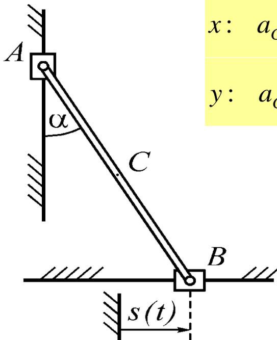
**Primer 2.13** Štap  $AB$ , prikazan na slici, vrši ravno kretanje. Tačka  $A$  se kreće pravolinijski u vertikalnom pravcu. Tačka  $B$  se kreće se pravolinijski u horizontalnom pravcu. Podaci su:
