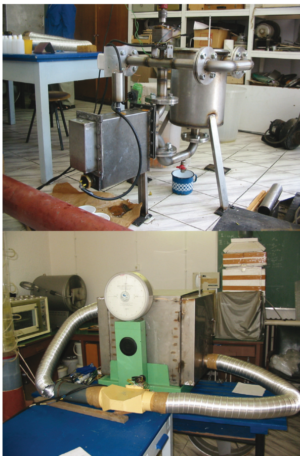
Sl. 1. Osmotska i konvektivna pilot sušare Fig. 1. Osmotic and batch convective pilot dryers
