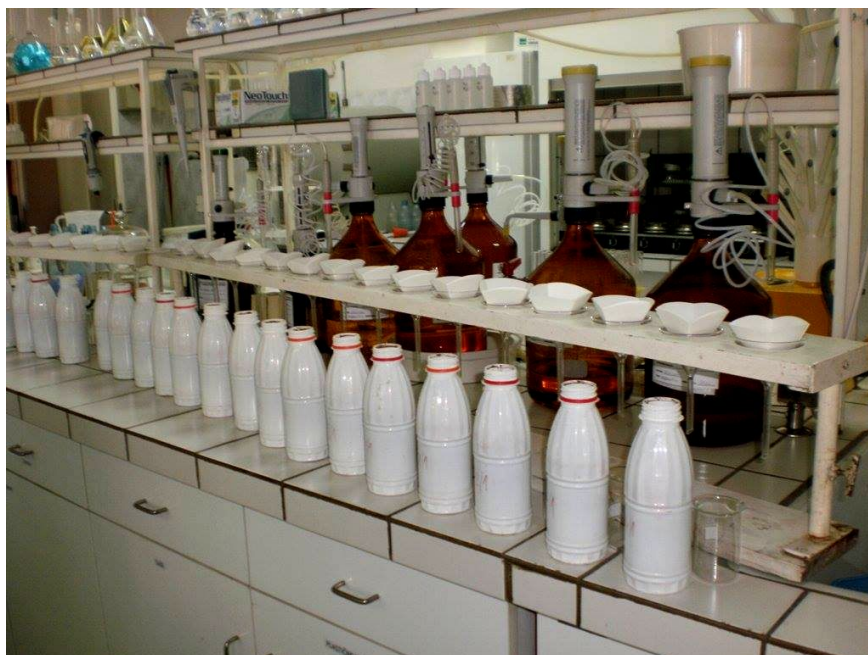
Слика 6. Филтрирање узорака у лабораторији Института за ратарство и повртарство (ориг.)
