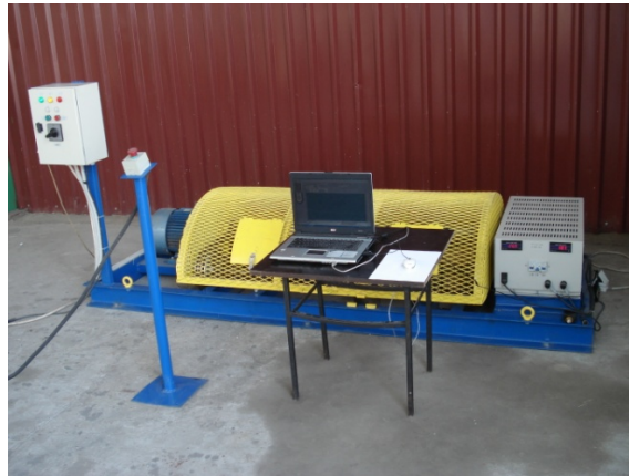
Слика 2. Испитивање тренутне поузданости пољопривредних карданских вратила
