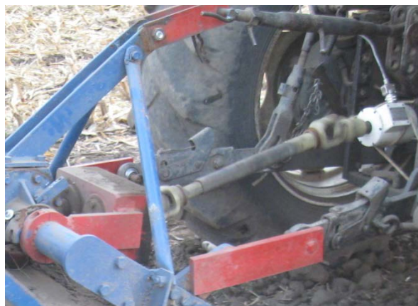
Слика 4. Адаптација тачака за прикопчавање ротационе ситнице са инвертором смера обртања ротора на трактор
