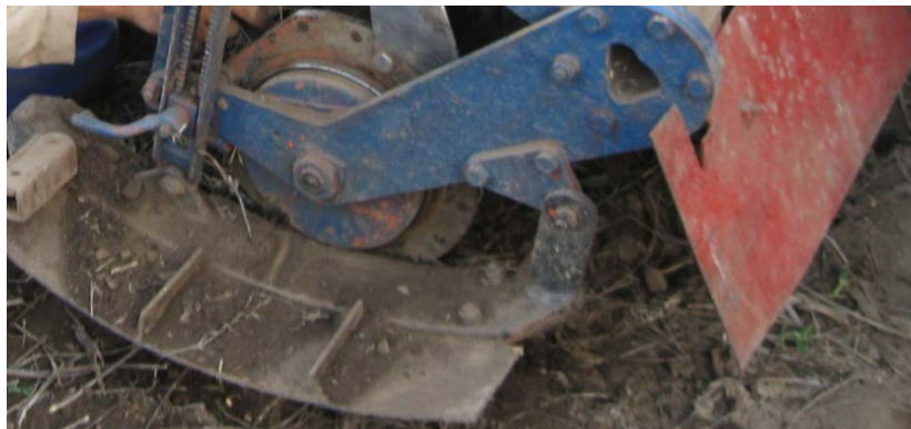
Слика 6. Клизач за одржавање радне дубине и заштитна даска са предње стране
