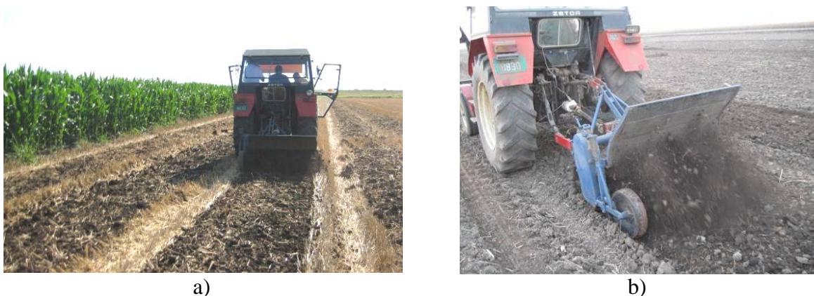
Слика 1. Ротациона ситница са инвертором смера обртања у току испитивања приликом рада у различитим услова (стриште и орано)
