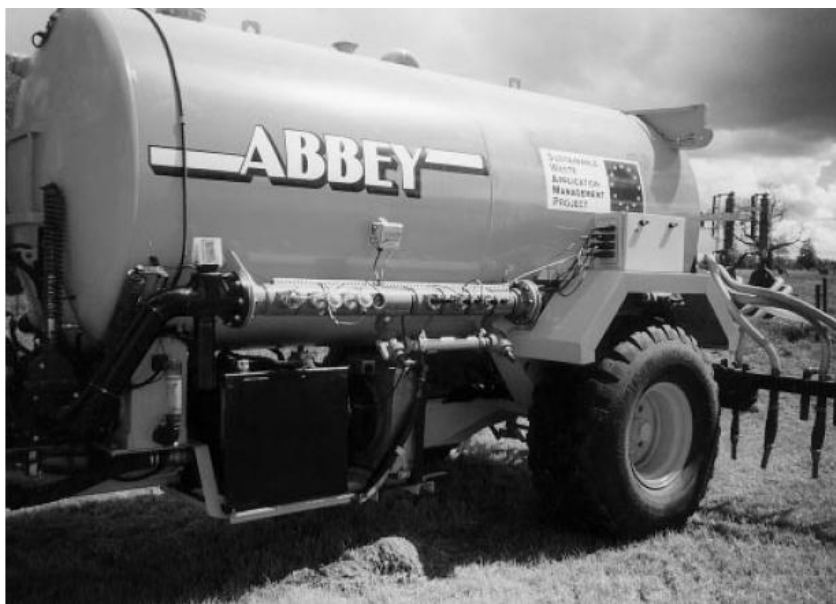
Slika 4.11 Tanker tečnog stajnjaka opremljen prototipom nutrientskog senzora. Kompjuterske informacije koriste za kontrolu primene stajnjaka po zemljištu na bazi GPS tehnologije i prethodno memorisanih podataka o tretiranoj parceli sa adekvatnim usevom, SWAMP projekat
