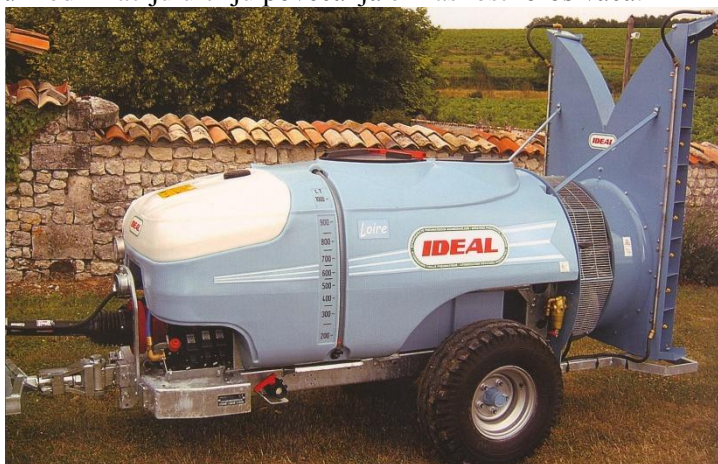
Slika 3.3 Orošivač sa usmerivačem i vertikalno postavljenim rasprskivačima
