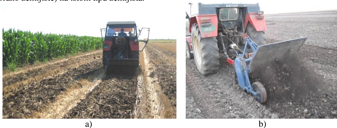
Slika 2.46 Merenje energetskih parametara rotacione sitnilice za različite uslove parcele (Ponjičan, 2009c): a) na strništu; b) na oranom zemljištu
