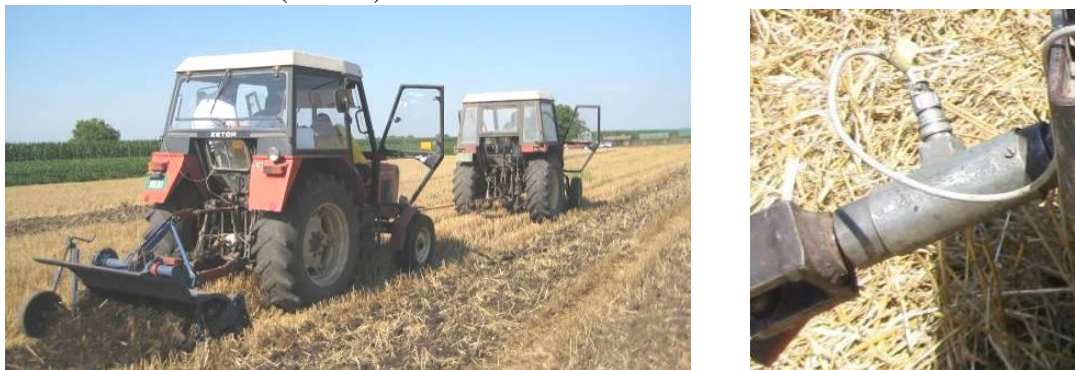
Slika 2.40 Merenje vučnog otpora na strništu (Ponjičan, 2009c)
