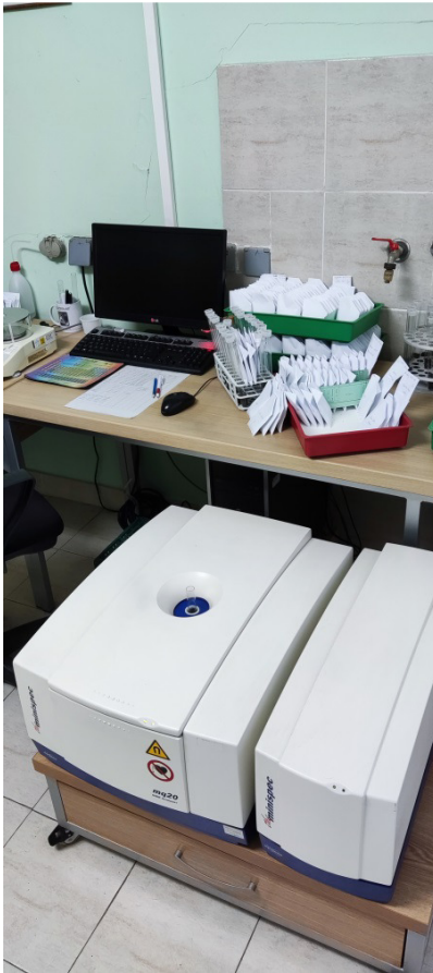
Слика 7. Апарат за испитивање садржаја уља (фото Васин, 2023)
