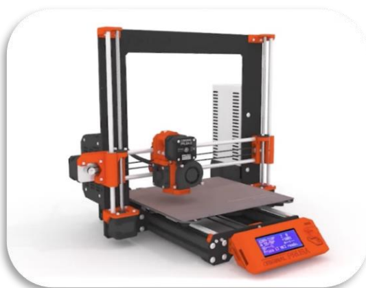
Слика 24. Изглед коришћеног 3Д штампача ( Prusa i3 MK3S+ )
