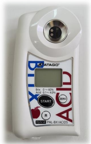
Слика 9. Уређај за мерење садржаја растворљивих сувих материја и укупних киселина плода јабуке (Фото: Тодић, 2022)
