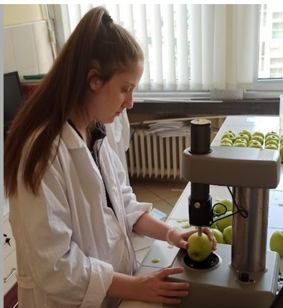
Слика 13. Мерење чврстине плодова (Фото: Скакун А.)
