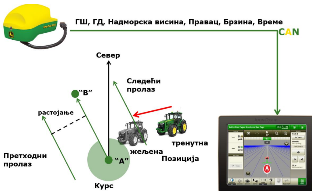
Слика 13 Одређивање АБ линије вођења
