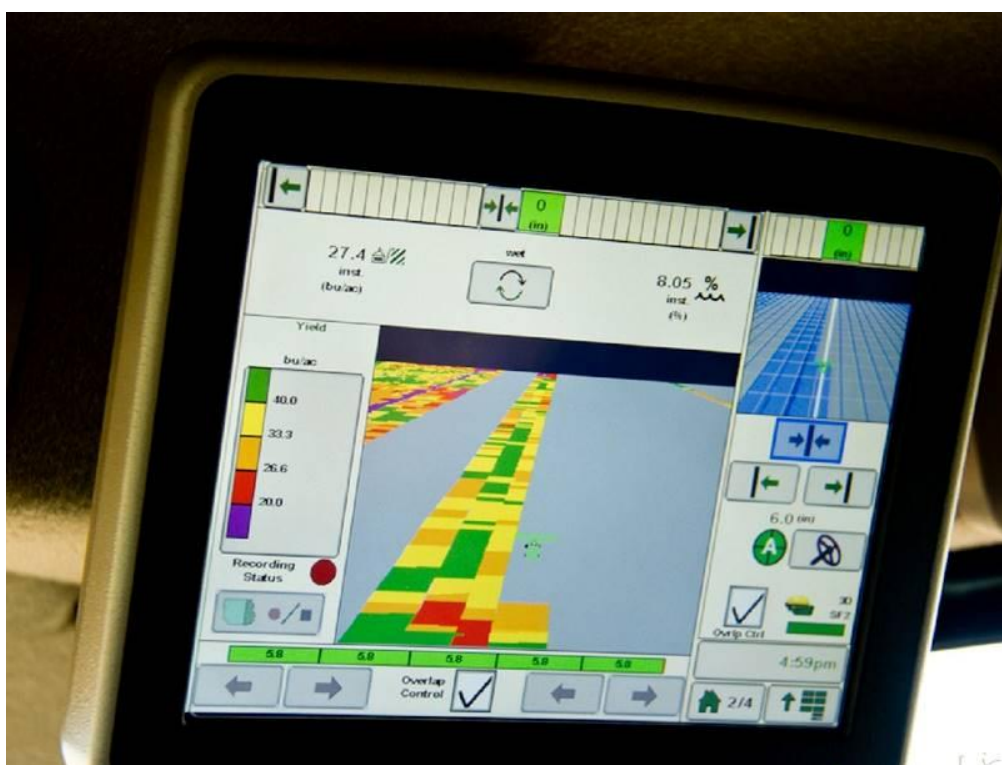
Слика 6 Мапа приноса на монитору комбајна
