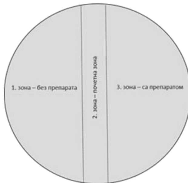
Слика 10. Приказ зона на филтер хартији у петри посудама које су коришћене у тестовима (извор: Lazić, 2022 )
