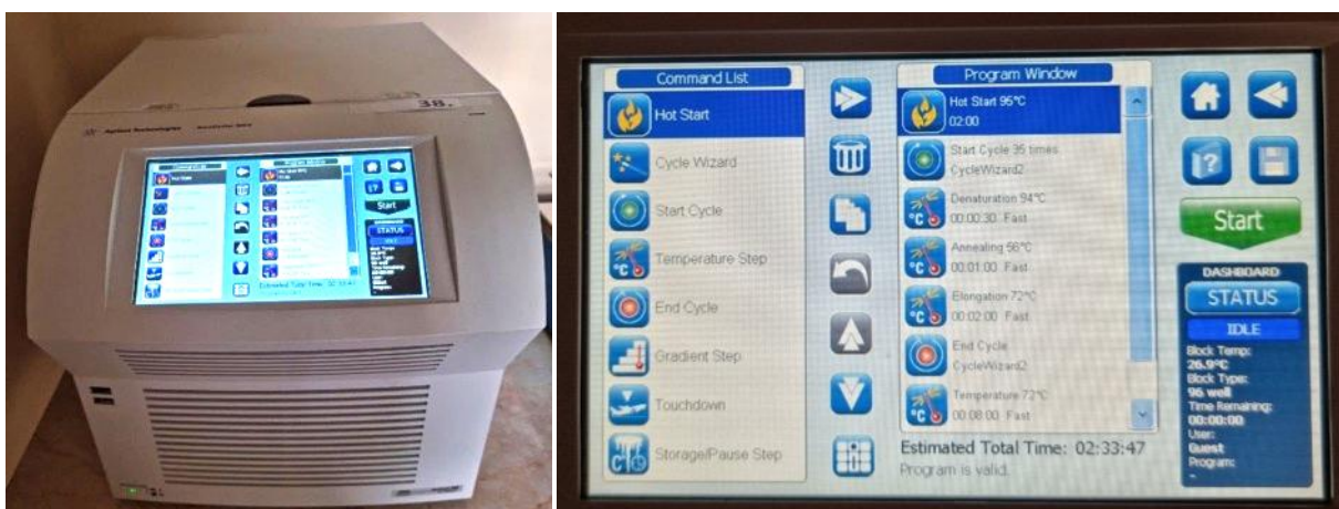
Слика бр. 3: Уређај Agilent SureCycler 8800 са покренутим условима PCR реакције (Фото: ориг)
