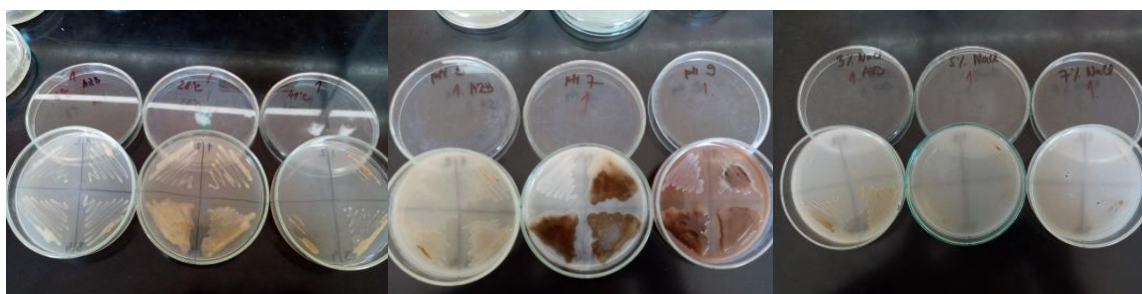
а) б) ц) Слика 21. Утицај температуре (а), рН (б) и соли (ц) на развој колоније изолата рода Azotobacter (Фото Годић)
