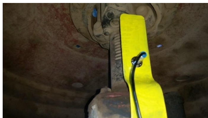
Слика 30. Мерење коефицијента проклизавања на точковима (Фото Н. Јапунџић 2017.)
