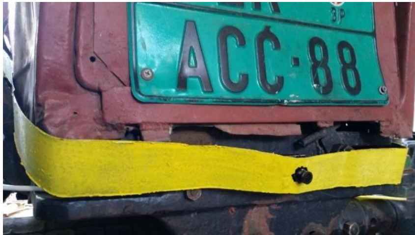
Слика 33. IP камера на предњици трактора
