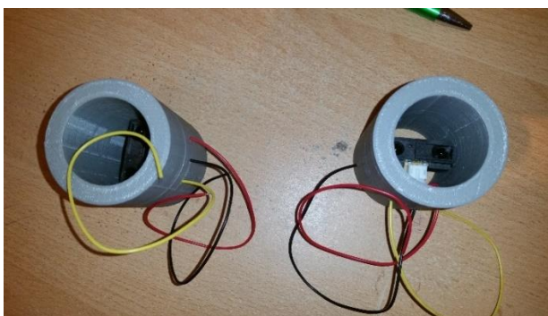
Слика 21. Sharp IR сензори раздаљине са 3D одштампаним носачима (Фото Н. Јапунџић 2017.)
