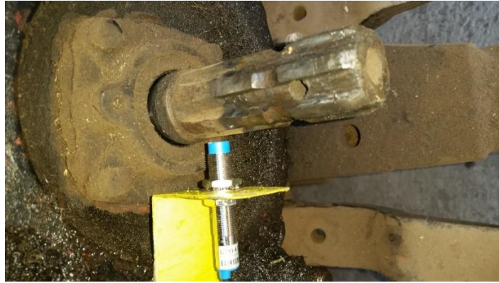
Слика 31 Мерење броја обртаја прикључног вратила
