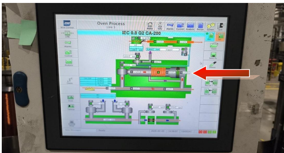
Слика 2: HMI дисплеј за праћење параметара температуре на машинама за производњу бакарне жице
