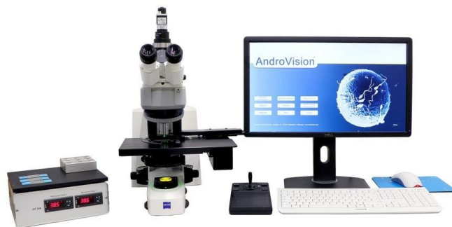
Слика 6. Уређај за одређивање концентрације и покретљивости сперматозоида (CASA) ( www.minitube.com )
