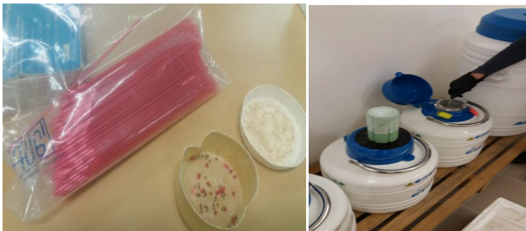
Слика 11. Пајете намењене за криопрезервацију семена. Слика 12. Контејнери течног азота (извор обе слике: приватна архива)
