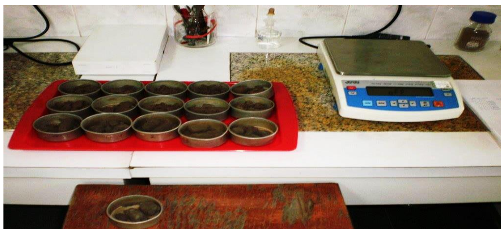
Слика 1. Одређивање садржаја влаге у земљишту у лабораторији Института за ратарство и повртарство у Новом Саду Извор: Оригинал аутора
