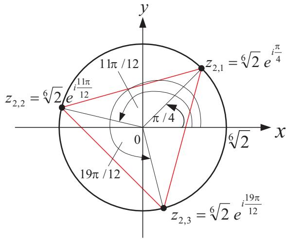
Slika 1.15: Geometrijski prikaz  $\sqrt[3]{z_2} = \sqrt[3]{-1+i}$  sa rešenjima  $z_2 = z_{2,1}$ ,  $z_2 = z_{2,2}$  i  $z_2 = z_{2,3}$ .
