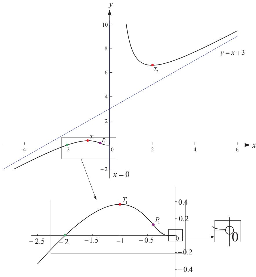
Slika 6.10: Grafik funkcije  $f(x) = (x+2)e^{\frac{1}{x}}$  gde je:  $x = -2$  nula funkcije,  $T_1(-1, \frac{1}{e})$  - lokalni maksimum,  $T_2(2, 4\sqrt{e})$  - lokalni minimum. Prevojna tačka je  $P_1 \left(-\frac{2}{5}, \frac{8}{5e^2\sqrt{e}}\right)$ . Prava  $x = 0$  je vertikalna asimptota kada  $x \rightarrow 0^+$ , a  $y = x + 3$  je kosa asimptota.
