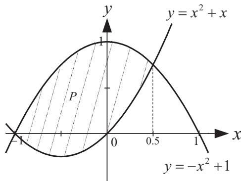
Slika 8.19: Površina ravnog lika između funkcija  $y = -x^2 + 1$  i  $y = x^2 + x$ .
