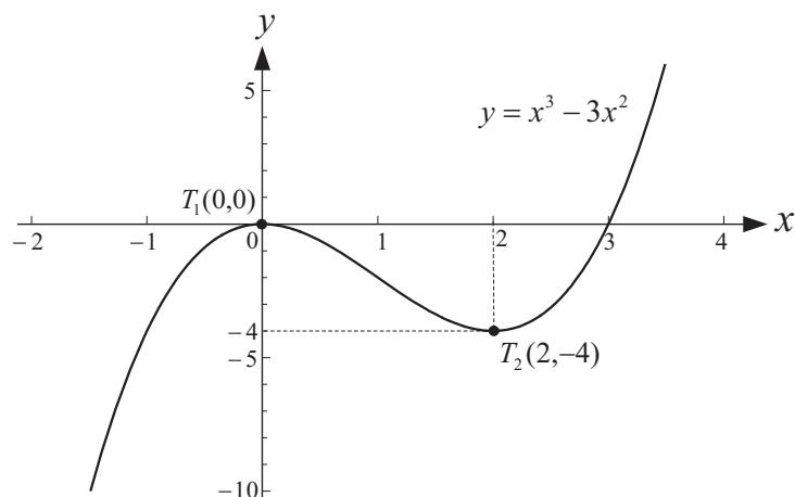
Slika 6.4: Grafik funkcije  $f(x) = x^3 - 3x^2$  sa lokalnim maksimumom u  $T_1$  i lokalnim minimumom u  $T_2$ .
