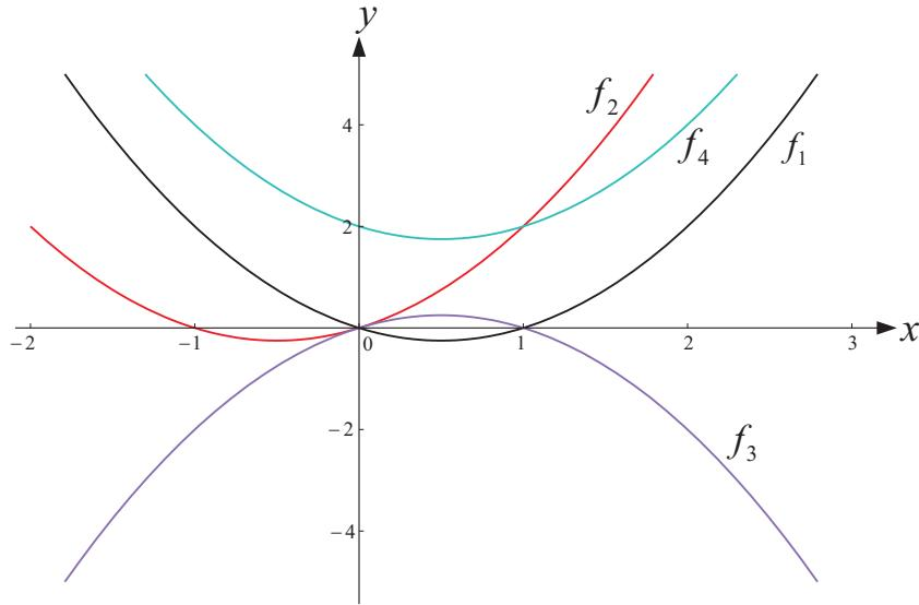
Slika 2.46: Grafici funkcija  $f_1(x) = x^2 - x$ ,  $f_2(x) = f_1(-x)$ ,  $f_3(x) = -f_1(x)$  i  $f_4(x) = f_1(x) + 2$
