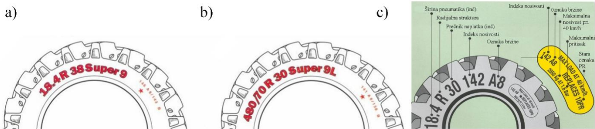
Sl. 4. Označavanje pneumatika: a) anglo-saksonske mere; b) ISO mere; c) novije oznake Fig. 4. Marking of tires: a) Anglo Saxon rates; b) ISO rates c) new rates
