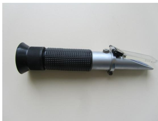
**Slika 13.4.** Ručni refraktometar
