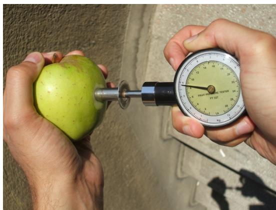
Slika 13.3. Ručni penetrometar
