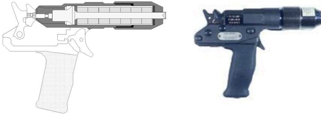
Slika VI-1. Pištolj za mehaničko omamljivanje životinja 23
