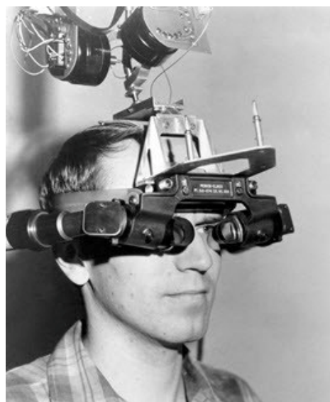
Сл. 2.12. Демаклов мач (енг. Sword of Damocles ) је био надимак за први екран на глави, изграђен 1968. год. 17
