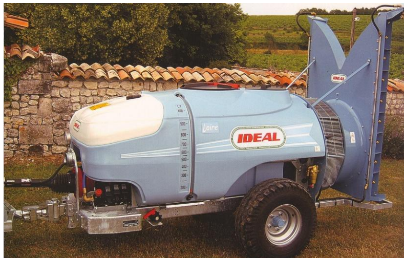
Slika 6.7. Orošivač s usmerivačima i vertikalno postavljenim rasprskivačima
