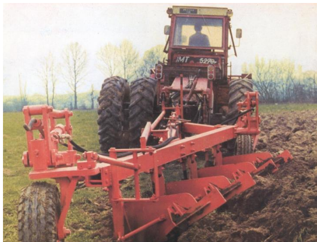
Slika 2.22. Traktor sa duplim točkovima a) traktor sa levim duplim točkovima, b) metalni rešetkasti točak
