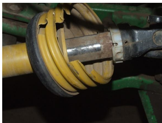
Slika 7.5. Provera priključnog i kardanskog vratila
