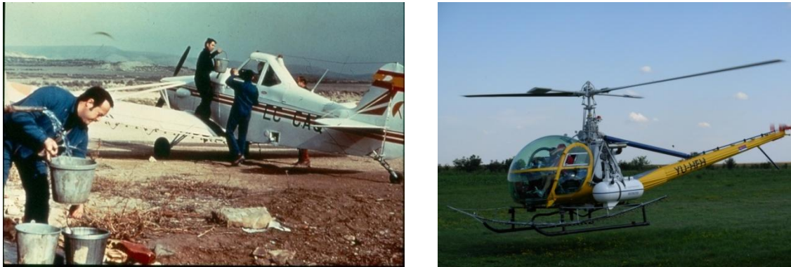
Slika 12.1. Avion i helikopter opremljen za tretiranje
