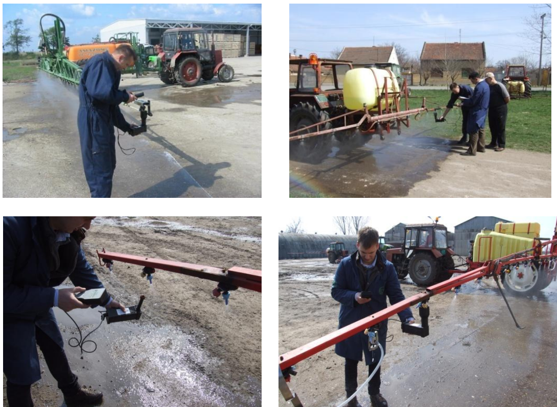
Slika 7.8. Provera pojedinačnog kapaciteta rasprskivača
