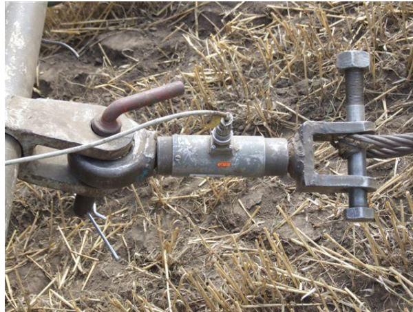
Slika 2.58. Izgled dinamometra prikopčanog na poteznicu traktora
