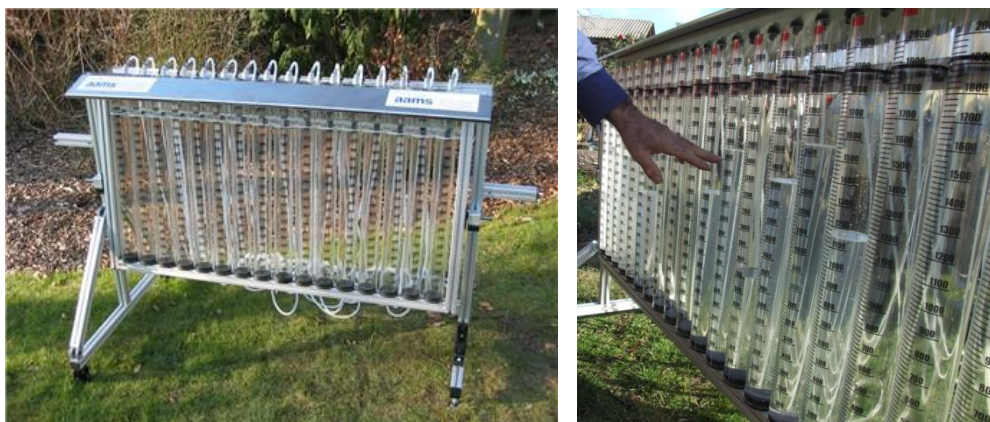
Slika 7.11. Merilo kapaciteta većeg broja rasprskivača
