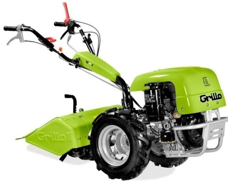
Slika 2.12. Jednoosovinski traktor sa rotacionim kultivatorom
