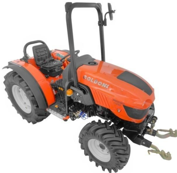
Slika 2.6. Voćarsko–vinogradarski traktor sa jednostrukim ramom
