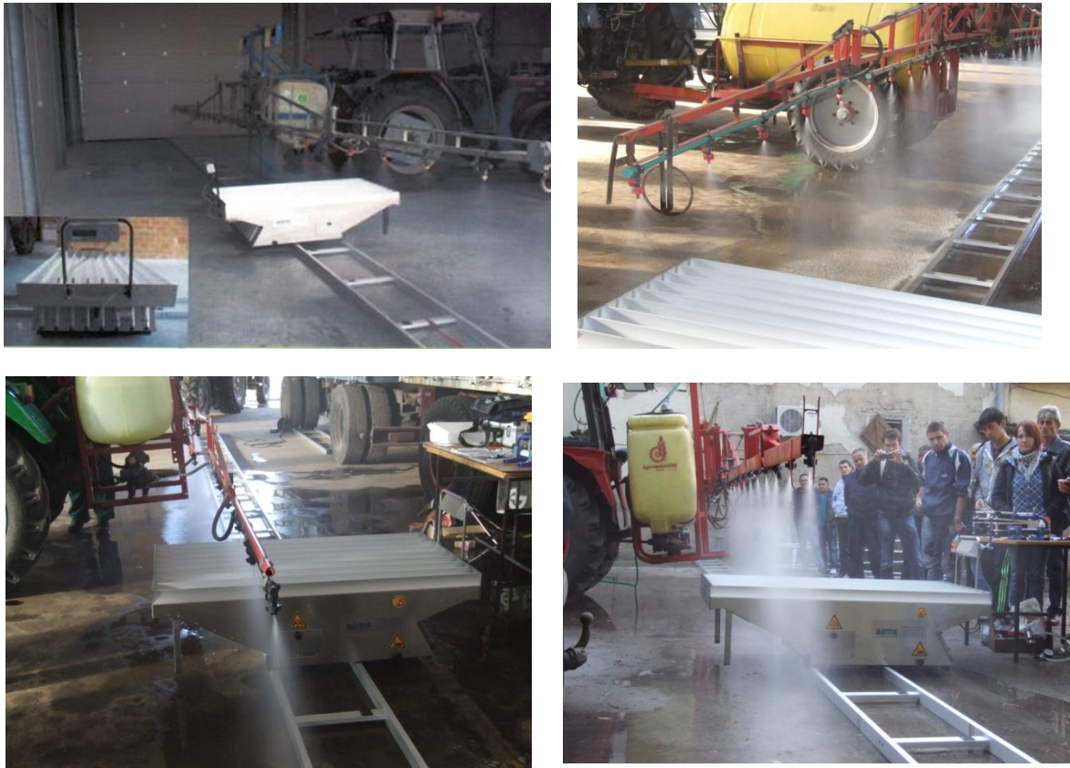
Slika 7.10. Sprej skener za kontrolu poprečne distribucije
