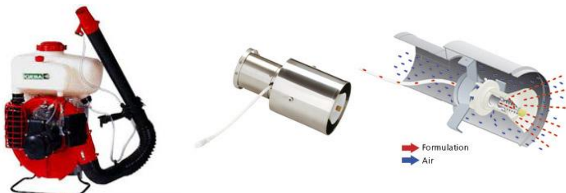
Slika 10.5. Adaptacija leđnog orošivača u generator hladnog aerosola
