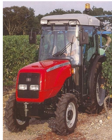
Slika 2.7. Voćarsko–vinogradarski traktor sa zaštitnom kabinom
