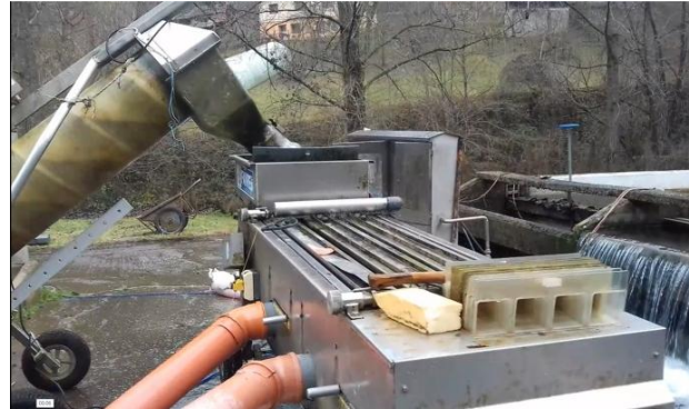
Слика 146. Машина за сортирање са аутоматским убацивањем пастрмки (Фото М. Урошевић)
