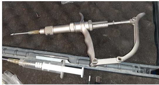
Слика 102. „Пиштољ“ и шприц за имплантацију чипа у тело рибе (Фото М. Урошевић)
