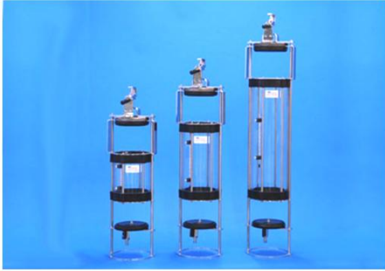
Слика 30: Рутнер-ова боца за узорковање воде на великим дубинама, запремине 1; 3 и 5 литара
