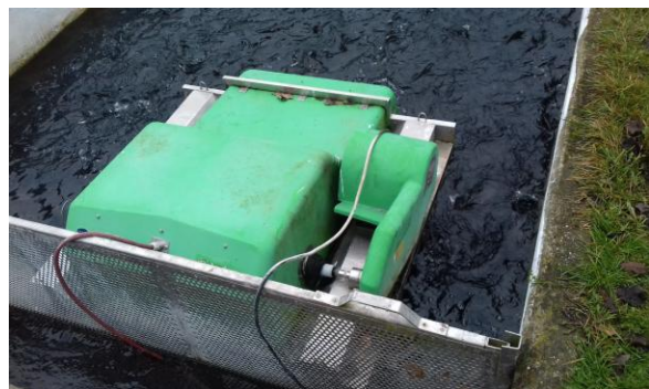
Слика 100. Оксигенатори (турбооксигени) за примену у пастрмском рибњаку (Фото М. Урошевић)
