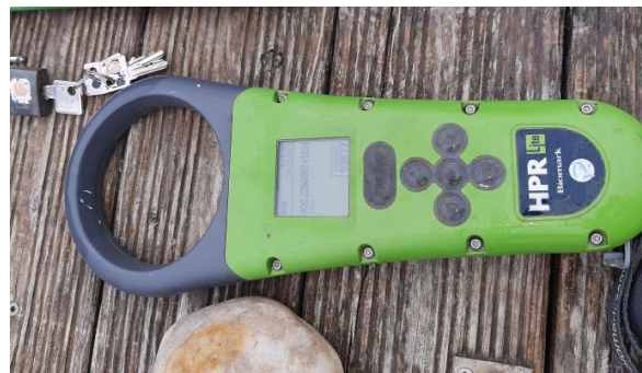
Слика 104. Уређај за очитавање имплантираног чипа у тело рибе (Фото М. Урошевић)
