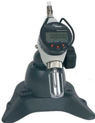
Sl. 2.39. Pneumatski komparator sa digitalnim displejom
