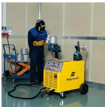
Sl. 5.35. Uređaj za elektrolučno zavarivanje AristoTIG 405 AC/DC
