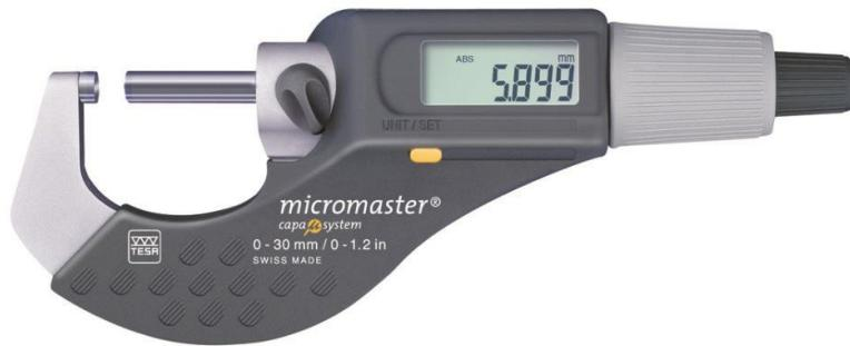
Sl. 2.31. Mikrometar za merenje spoljašnjih dimenzija sa elektronskim displejem proizvođača Micromaster
