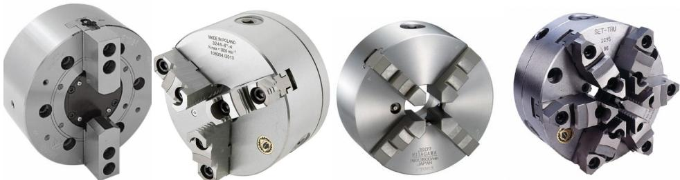
Sl. 3.37. Stezna glava za pozicioniranje obratka na strugu sa dve, tri, četiri i šest steznih šape
