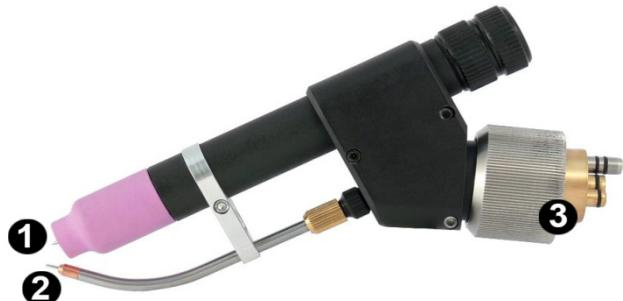
Sl. 5.34. Glava aparata za TIG postupak zavarivanja sa automatskim doziranjem žice
