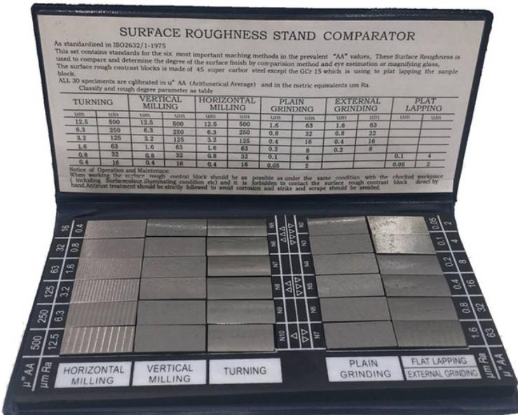
Sl. 2.75. Etalon za određivanje hrapavosti obrađene površine
