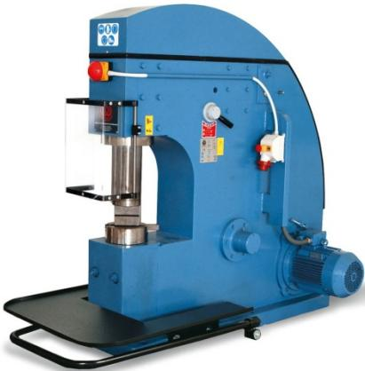
Sl. 4.35. *Vazdušni čekić AR50 (masa malja 50 kg, hod malja 230 mm, broj udara 220 min<sup>-1</sup>)*
