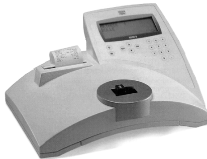
Slika 97. Fotometer za određivanje parametara sperme fotometrijom
