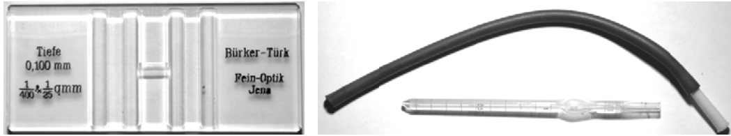
Slika 95. Oprema za brojanje spermatozoida metodom hemocitometrije Za spermu nerasta se koristi leukocitarni melanžer (može se napraviti razrjeđenje 1:10 ili 1:20)
