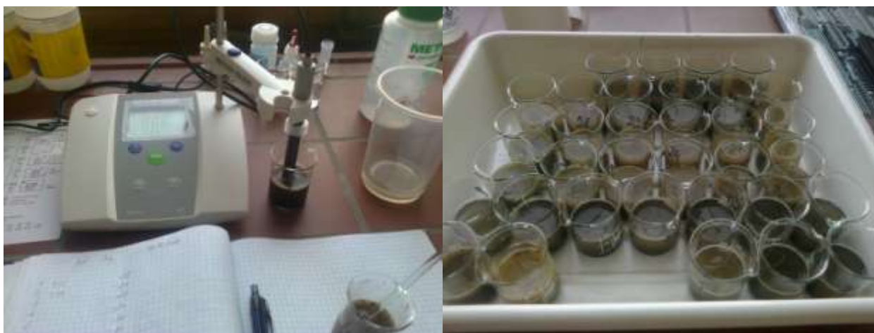
Слика 16. Мерење pH вредности суспензије земљишта у води и калијум хлориду
