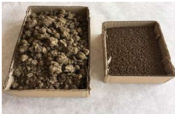
Слика 13. Узорци земљишта пре (лево) и после (десно) уситњавања
