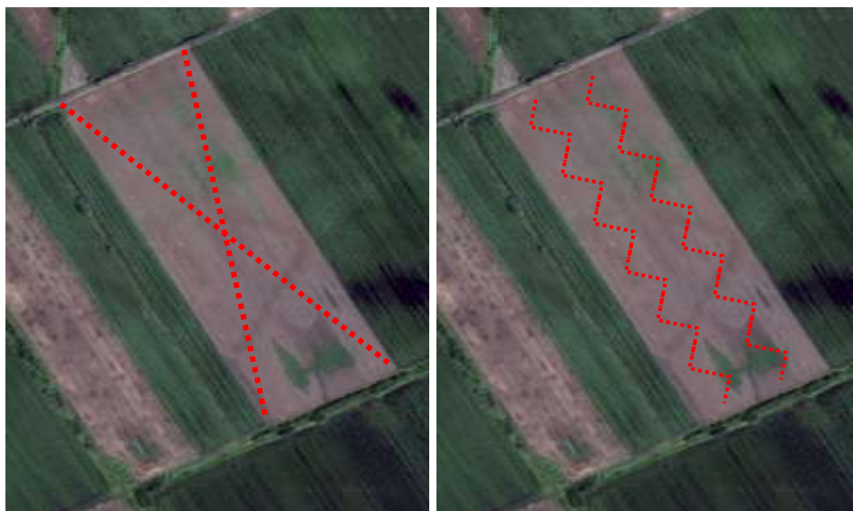
Слика 6. Узорковање по дијагоналном и шаховском распореду
