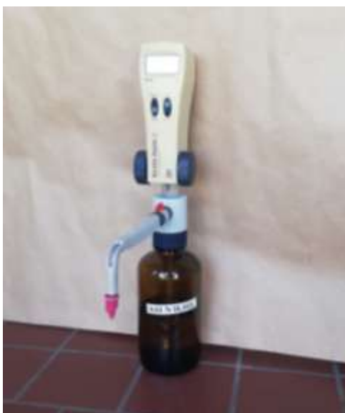
Слика 21. Аутоматска бирета за титрацију са 0,01 N H 2 SO 4
