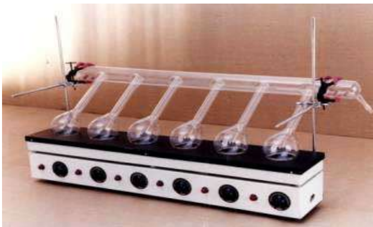
Слика 19. Кјелдахл балони на решоу за разарење органске материје земљишта
