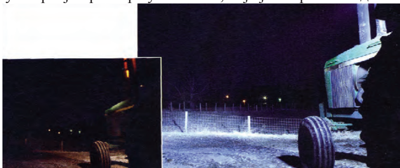
Слика 9.9. Разлика у светлости између халогене и LED сијалице
