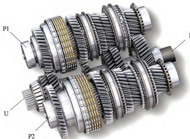
Слика 2.62. „Директдрајв“ (DirectDrive) мењач на тракторима „џон дир“ (John Deere): U. улазно вратило; P1. помоћно вратило 1; P2. помоћно вратило 2; I. излазно вратило
