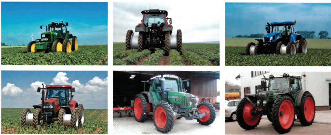
Слика 4.26. Удвајање точкова фирме „Грасдорф“ (Grasdorf) за различите културе
