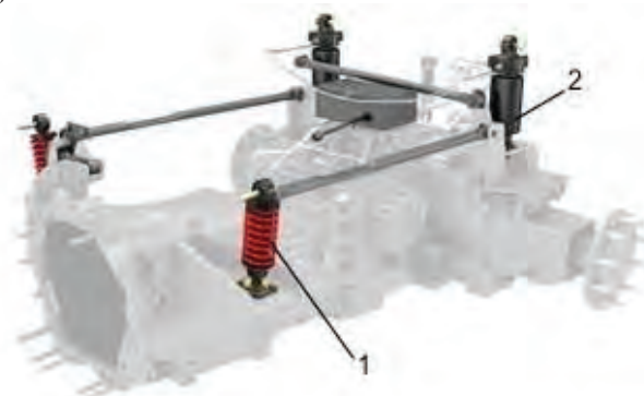
Слика 10.9. Хидропнеуматски систем ослањања: 1. опруга; 2. хидраулички или пнеуматски цилиндар
