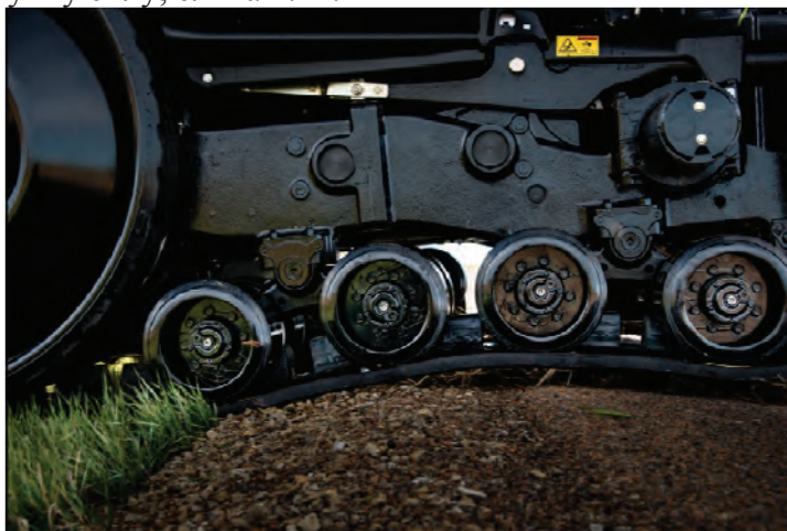
Слика 4.41. Еластично ослоњени потпорни ваљци на тракторима „челенџер“, серије МТ 700
