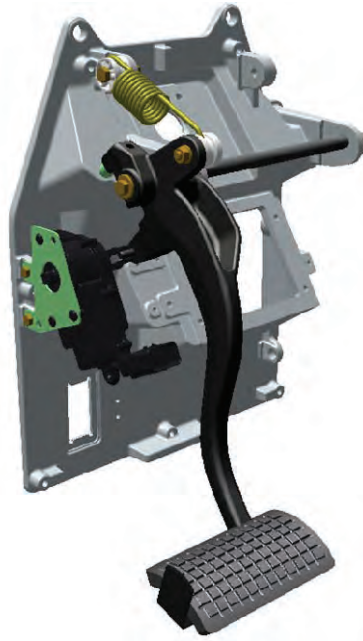
Слика 2.12. Педала спојнице са сензором положаја на тракторима „масеј фергусон“ серије 8700
