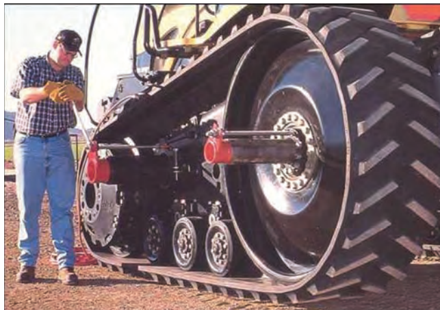
Слика 4.40. Подешавање ширине трага гусенице код трактора „челенцер“, серије МТ 700 и 800
