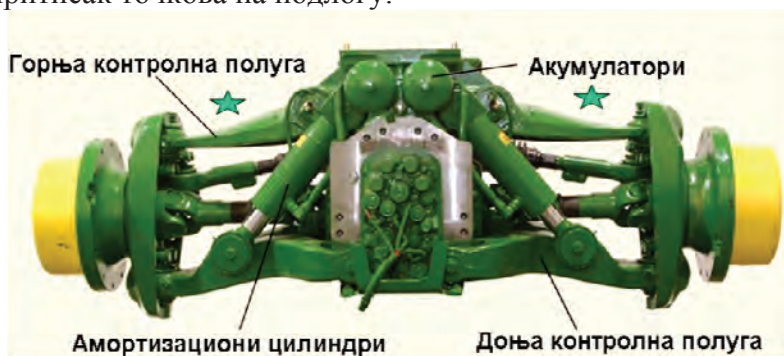
Слика 10.12. Независно ослањање предњег моста ILS систем „индпеднт линк суспеншн) ( Independent Link Suspension )
