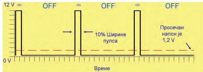
Слика 9.28. Соленоидни пропорционални вентил је искључен „OFF“
