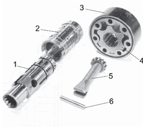
Слика 5.16. Делови орбитрола: 1. клипни вентил; 2. цеваста вентил; 3. спољашњи ротор; 4. унутрашњи ротор; 5. вратило; 6. чивија
