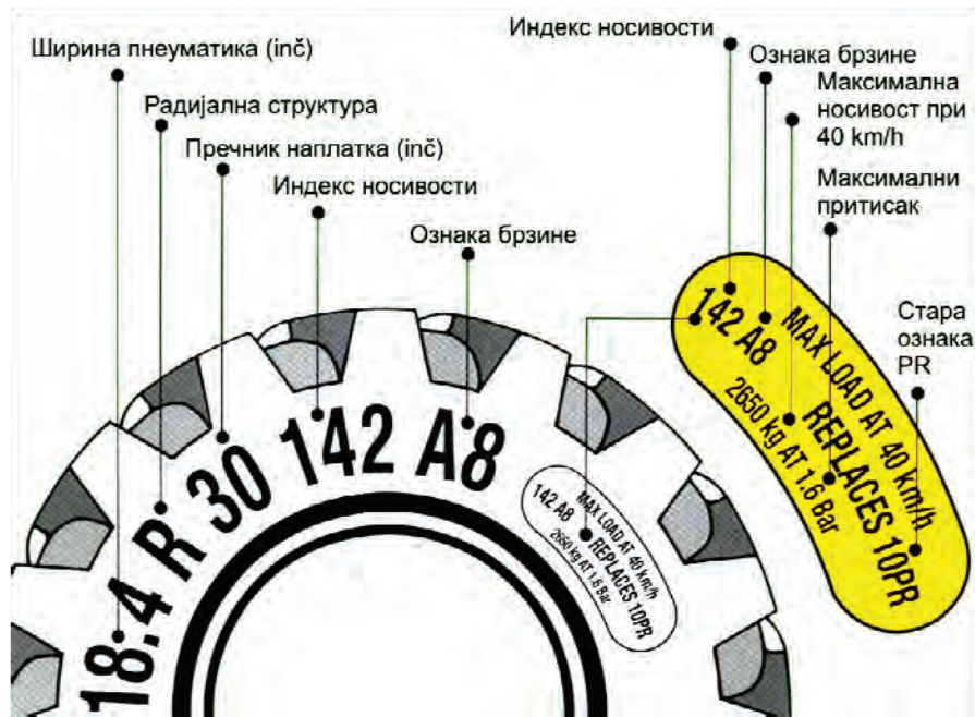
Слика 4.13. Ознаке на пнеуматику
