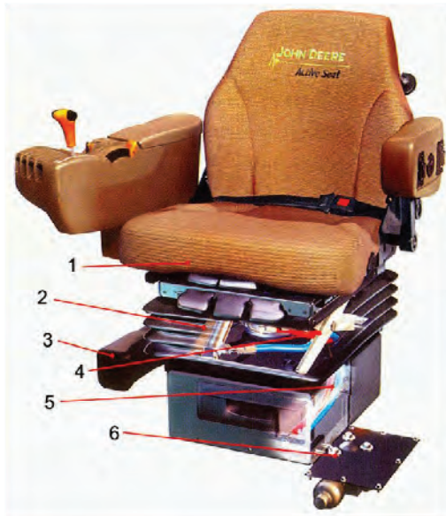
Слика 10.8. Пресек седишта „актив сит“ ( Active Seat ): 1. сензор убрзања; 2. актуатор – хидропнеуматски цилиндар; 3. помоћни резервоар са ваздухом; 4. сензор положаја; 5. електронска управљачка јединица; 6. електрохидраулички разводник
