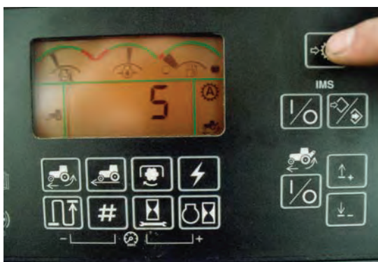
Слика 2.67. Прекидач за укључење аутоматске промене степена преноса на тракторима „дон дир“, серије 8010 и 8020
