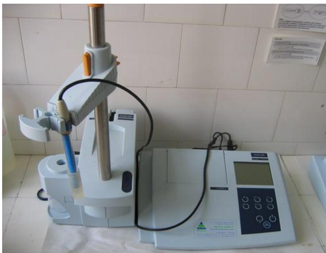
*Slika 29. Električni pehametar sa dvojnom kombinovanom elektrodom.*
