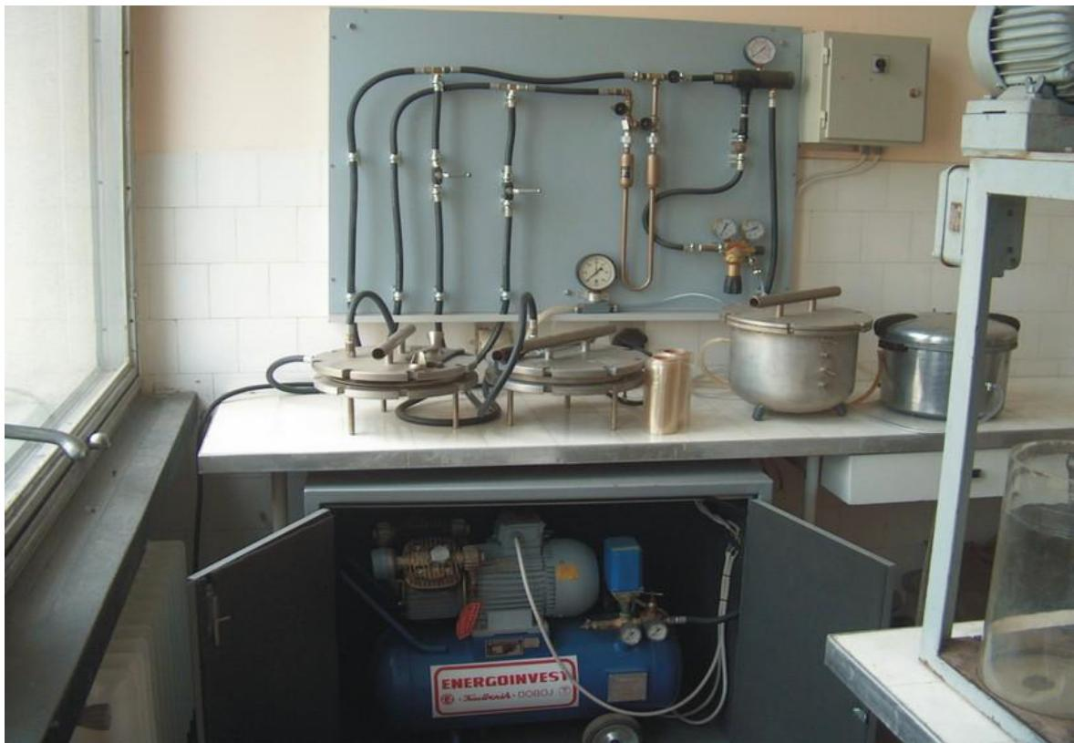
*Slika 22. Aparatura za određivanje retencije*
