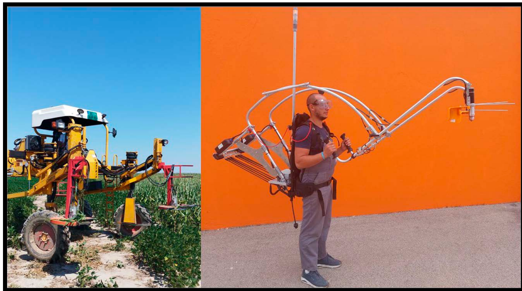
Слика 29. Лево KWS платформа за механичко уклањање метлица, десно ручни кастрикс за мање парцеле.
