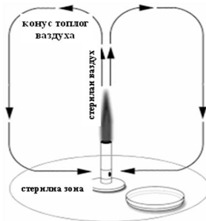
Слика 3. Зона стерилне површине ( \varnothing око 40 cm) и стерилног простора око пламеника
