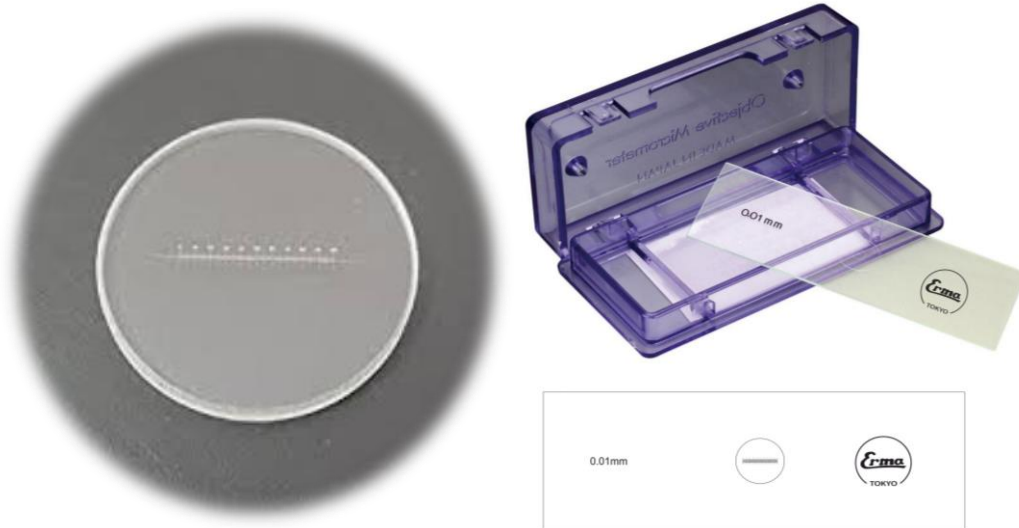
Слика 31. Окуларни микрометар (лево) и објективни микрометар (десно)
