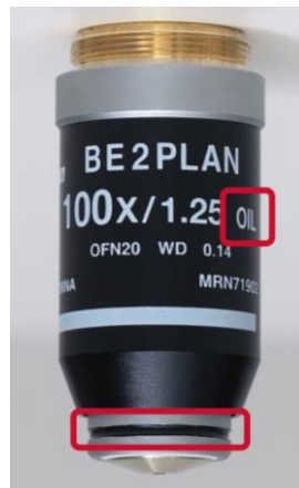
Слика 29. Имерзиони објектив 100× увећање са урезаним црним прстеном
