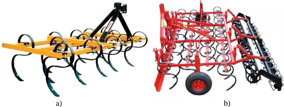
Slika 3.41. Kultivatori: a) perasti (opružni), b) kombinovani
