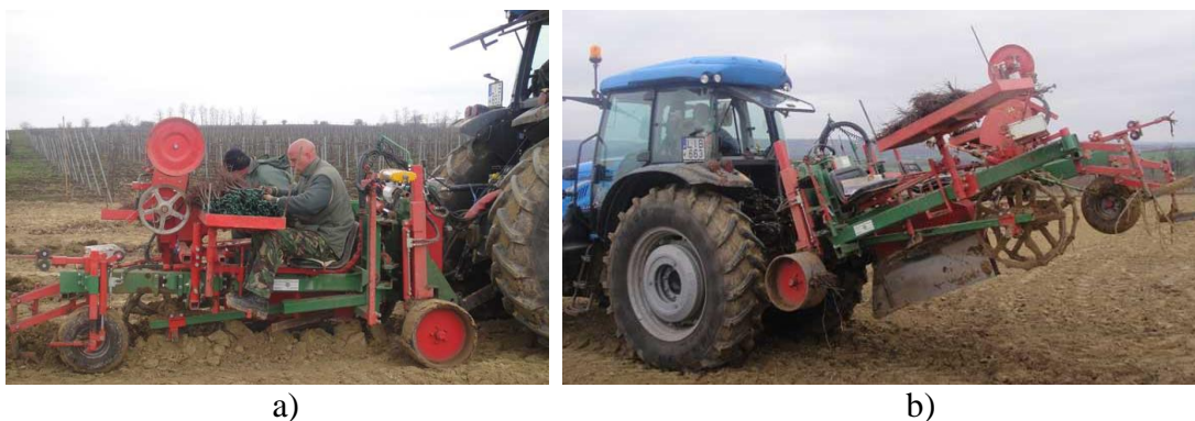
Slika 4.6. Sadilica loznih kalemova: a) u radnom položaju, b) u transportnom položaju
