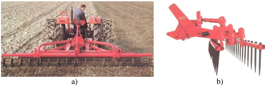
Slika 3.48. Prinudno klateća (oscilirajuća) drljača: a) u radu (kombinovana sa rešetkastim valjkom pozadi), b) izgled mašine
