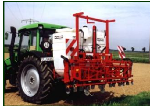
1-poluge, 2-zglobovi, 3-nosač, 4-ram prskalice, 5-nosač krila, 6-oslonac, 7-hidrocilindri
