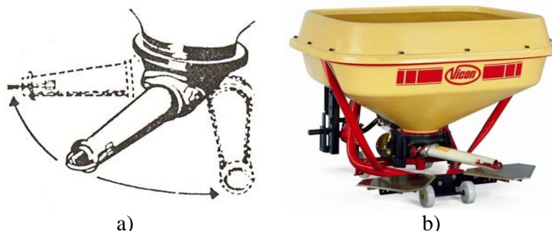
Slika 5.20. Rasipač sa klatećom cevi: a) klaćenje-sektor kretanja cevi, b) izgled nošenog rasipača
