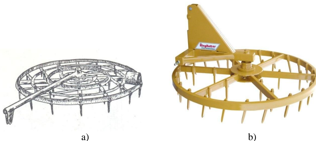
Slika 3.47. Prirodno rotirajuće drljače za voćarstvo i vinogradarstvo: a) vučena, b) nošena
