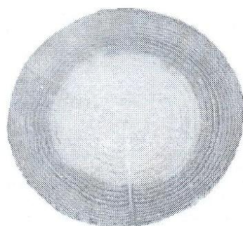
Slika 7.7. Presek drvenog stuba sa perifernim impregrisanim slojem
