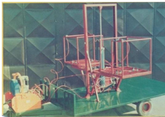
Slika 9.6. Adaptirana traktorska prikolica sa mestima za radnike i ambalažu
