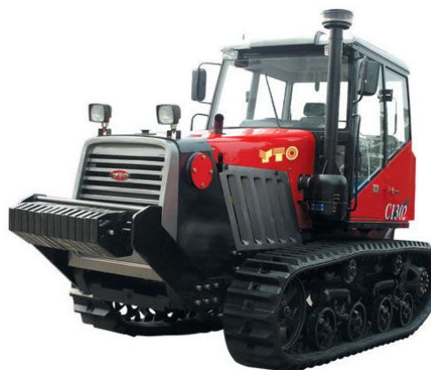
Slika 1.30. Šema traktora s elastičnom gusenicom
