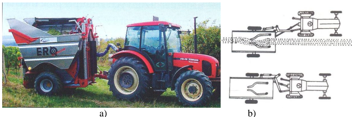
Slika 9.23. Vučeni kombajn za berbu grožđa: a) izgled agregata, b) šema kretanja vučenog kombajna u radu i transportu
