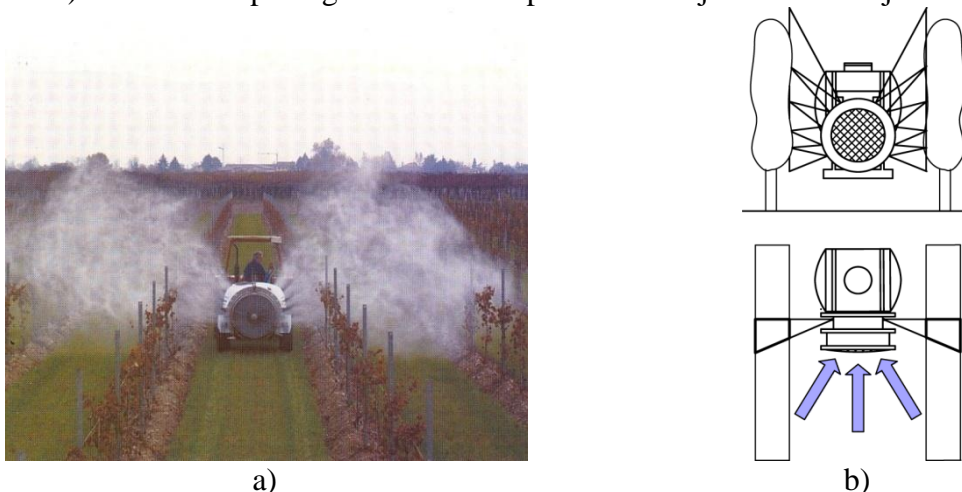
Slika 6.90. Klasični orošivač: a) u radu, b) šema usisavanja i potiskivanja tečnosti
