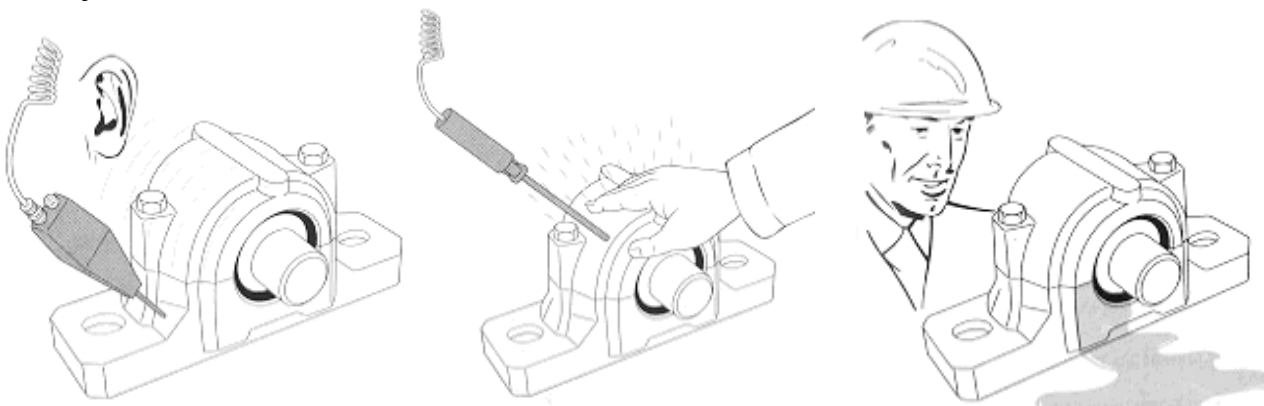
Sl. 10.47. Vizuelna kontrola ispravnosti ležaja
