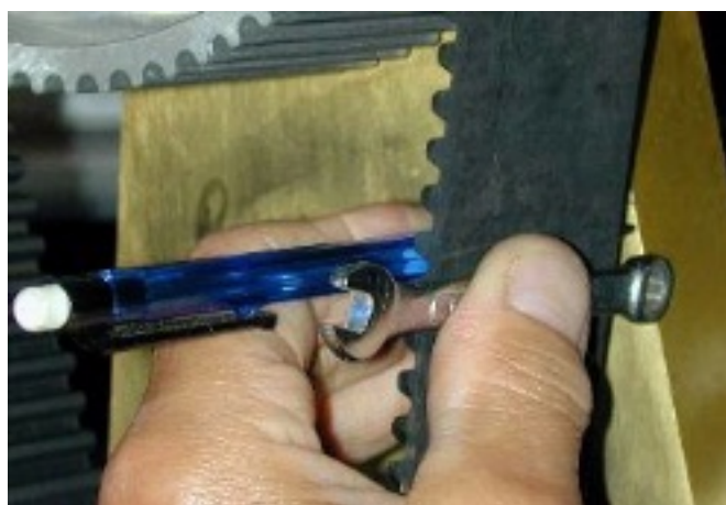
Sl. 8.28. Kontaktno merenje ugiba pomoću olovke
