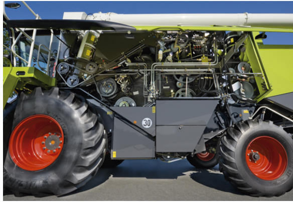
Sl. 8.23. Pogon radnih delova vršalice kombajna Claas Lexion 670 pomoću remena
