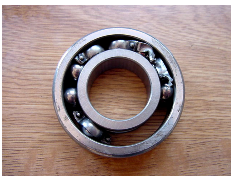
Sl. 10.61. Drobljenje i topljenje kotrljajnih elemenata ležaja
