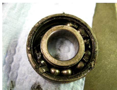
Sl. 10.61. Drobljenje i topljenje kotrljajnih elemenata ležaja
