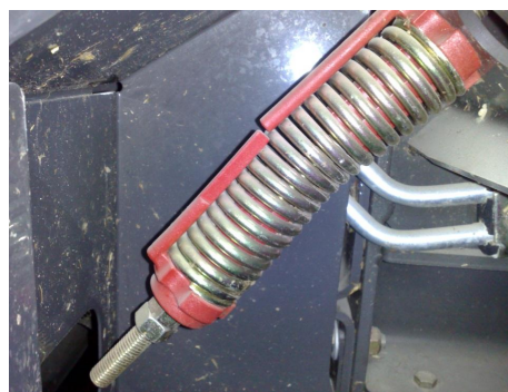
Sl. 8.27. Regulisanje zatezača kod kombajna Claas
