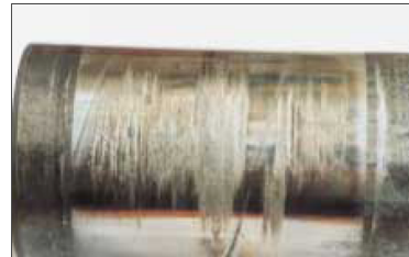
Sl. 7.27. Nagrizanje valjčića lanca
