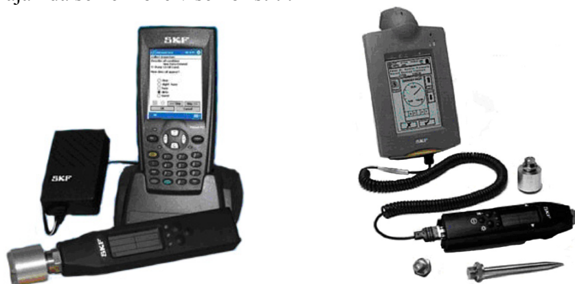
Sl. 10.48. SKF MARLIN uređaj za merenje stanja ležaja
