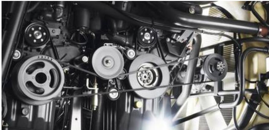
Sl. 8.24. Pogon sistema za hlađenje motora silažnog kombajna Claas Jaguar 980 pomoću remena
