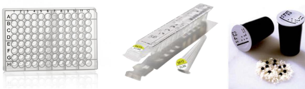
Slika 31: Različite čvrste podloge u kojima su upakovani testovi: mikrotitar ploča, test-strip kod Vidas-a i perlice u posudici kod TOSOH-a
