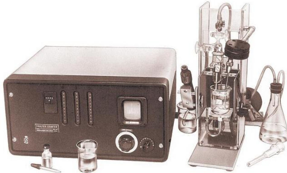
Slika 7: Prvi komercijalni model hematološkog brojača: Model A Coulter Counter
