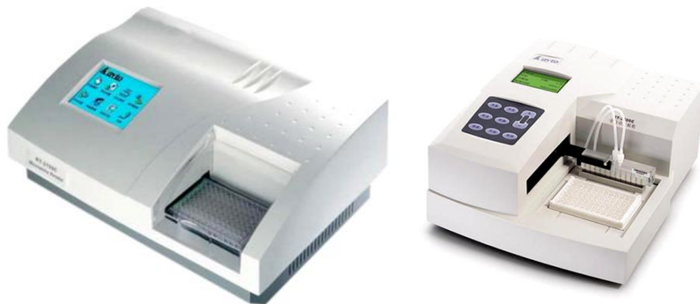
Slika 32: ELISA čitač (levo) i ispirać (desno) mikrotitar ploča
