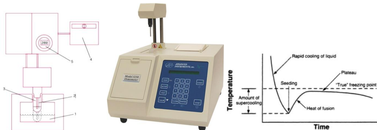
Slika 37: Šema osmometra, izgled osmometra i kriva odnosa vremena i temperature tokom osmometrijske reakcije
