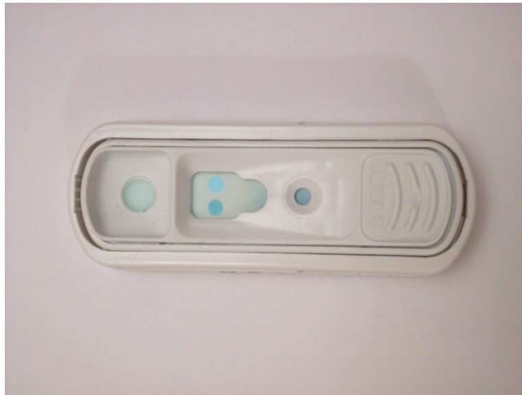
Прилог 16. SNAP тест за одређивање присуства резидуа антибиотика у млеку
