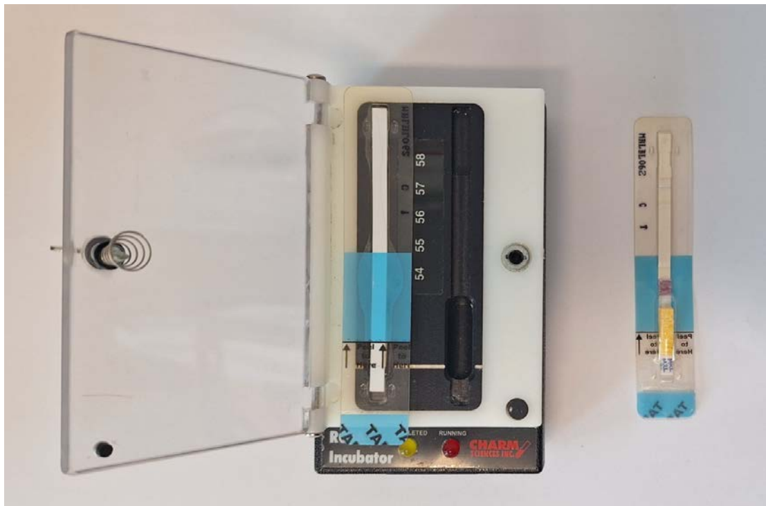
Прилог 17. Charm MRL™ тест - инкубатор и тест траке за одређивање присуства резидуа антибиотика у млеку
