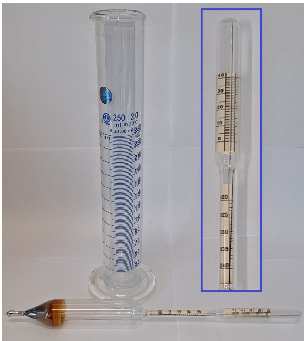
Прилог 8. Лактодензимерат и мензура (одређивање густине млека)
