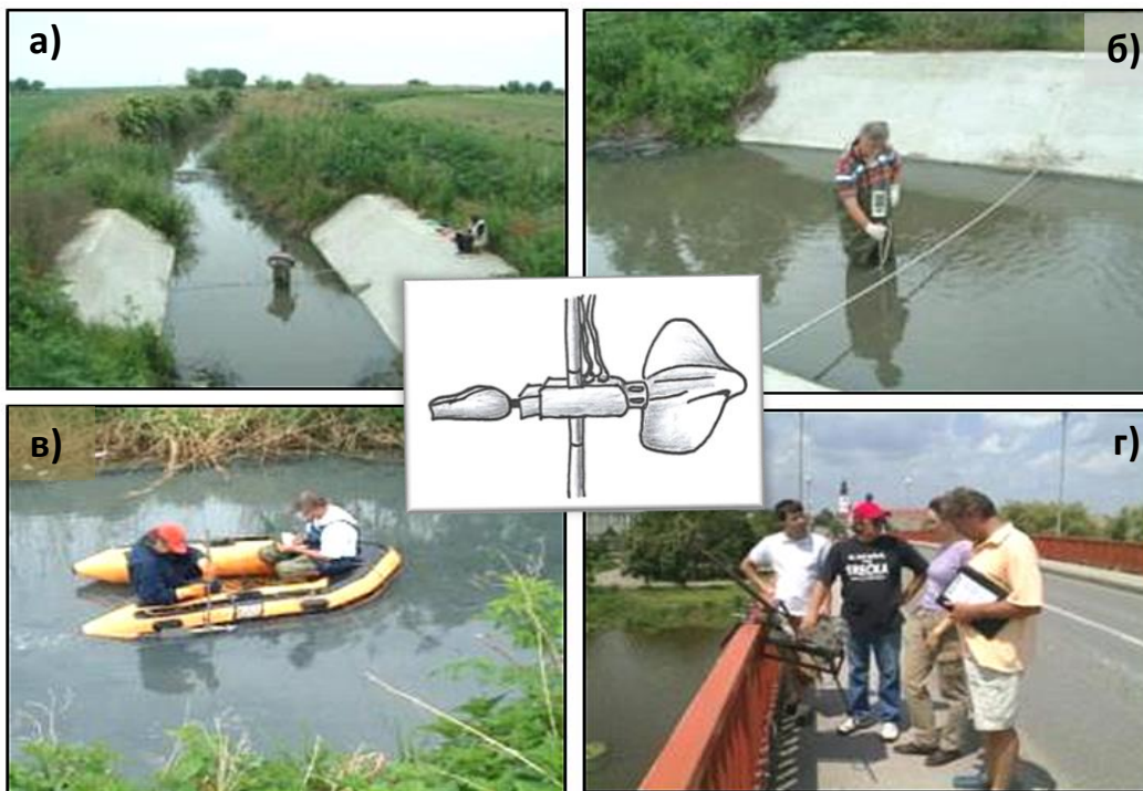
Слика 37. Мерење брзине тока уз помоћ хидрометријског крила: на мањем водотоку (а и б), из чамца (в) и са моста (г) (а–в, канал КЦЗ, Врбас; г – канал Бечеј–Богојево, мост код Србобрана)
