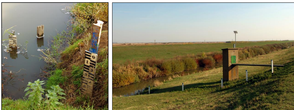
Слика 33. Водомерне летве на реци Брзави, гранични профил према Румунији (Фото: Атила Бездан; октобар 2017)
