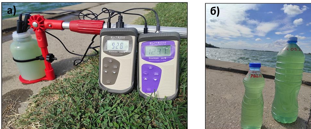
Слика 17. Контрола квалитета воде на терену: (а) електропроводљивости и засићености РК и (б) изглед узорковане воде (Палићко језеро, 24. септембар 2020)
