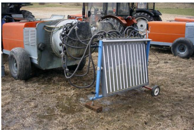
Slika 3.23 Provera kapaciteta distribucije rasprskivača orošivača
