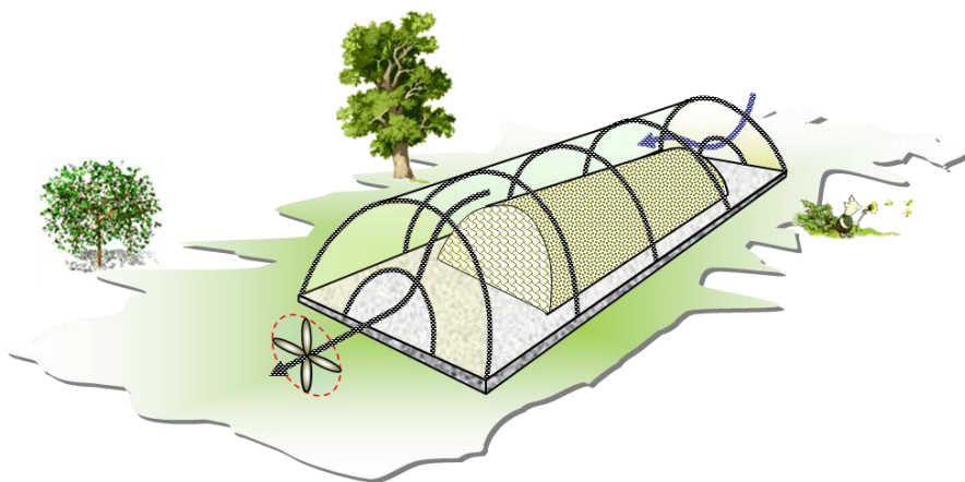
Slika 4.38 Šema eksperimentalno kompostirajuće jedinice upotrebom poklopca radi omogućavanja monitoringa generisane emisije
