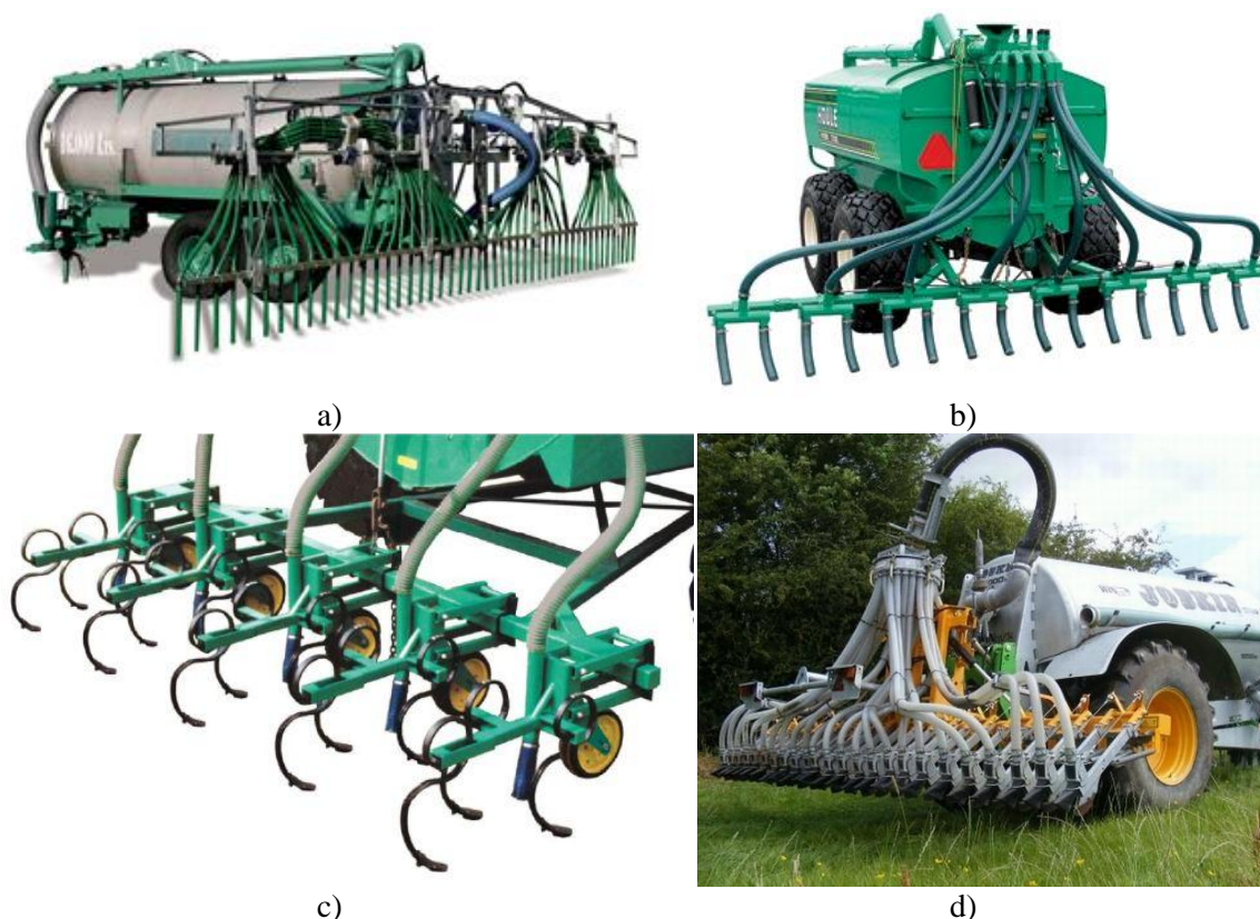
Slika 4.8 Sistemi za raspodelu tečnog stajnjaka: a i b- niskog površinskog nivoa, c i d- podzemnog nivoa-injekcija
