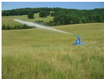
Slika 4.10 Varijanta zakretnih raspršivača tečnog stajnjaka
