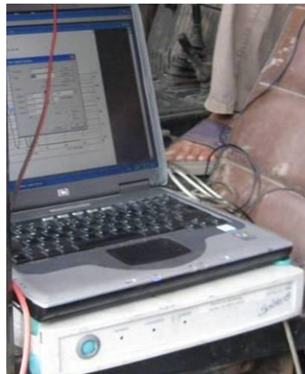
Slika 2.43 Akvizicija PC measurement electronic Spider 8 i notebook računara (Ponjičan, 2009c)
