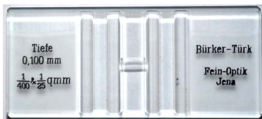
Slika 38. Oprema za brojanje spermatozoida metodom hemocitometrije
