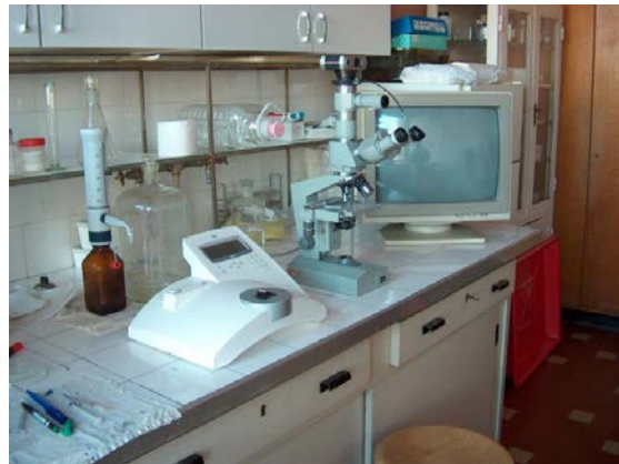
Slika 39. Fotometer za određivanje parametara sperme fotometrijom
