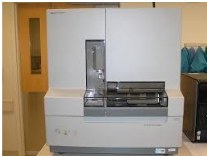
Слика 16: ДНК секвенцер; ABI Genetic Analyzer 3130 (Извор: Младенов, 2016.)
