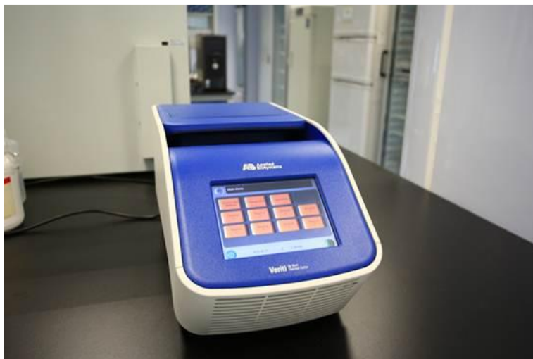
Слика 15. PCR апарат; Veriti Thermal Cycler . (Извор: Младенов, 2016.)
