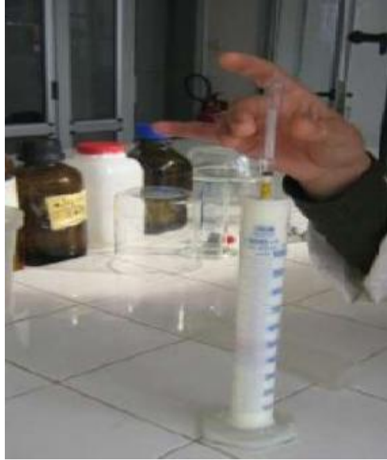
Слика 49. Мерење запреминске масе лактодензиметром (фото: аутор)
