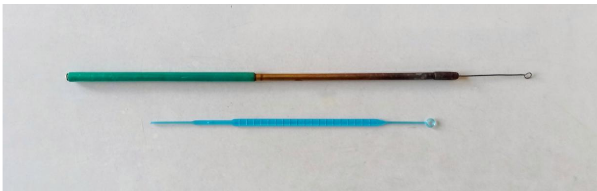
Слика 1.1. Омчаста бактериолошка еза (горе) и бактериолошка еза за једнократну употребу (доле) с омчастим и убудним крајем
