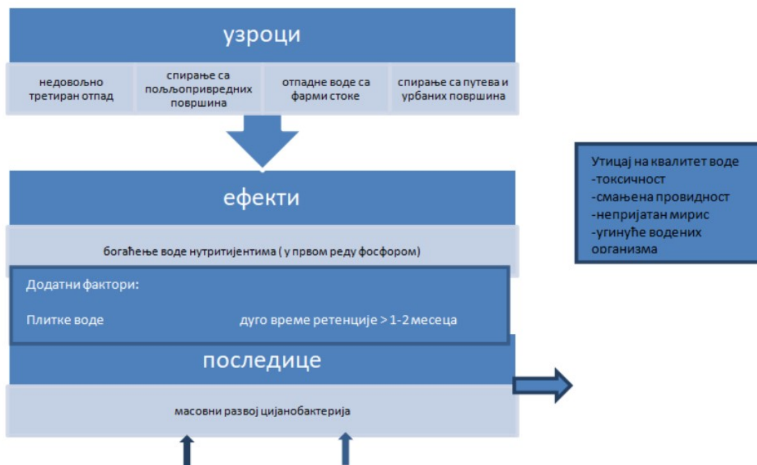
Слика 10. Шематски приказ узрока, ефеката и последица загађења вода (оригинал)
