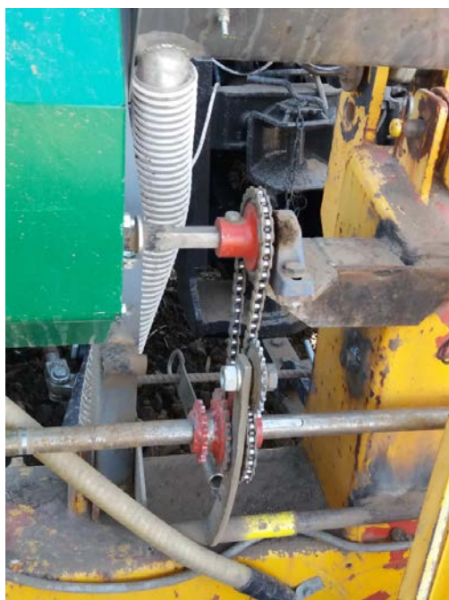
Слика 4. Подешен преносни однос за норму ђубрења 303,6 kg/ha
