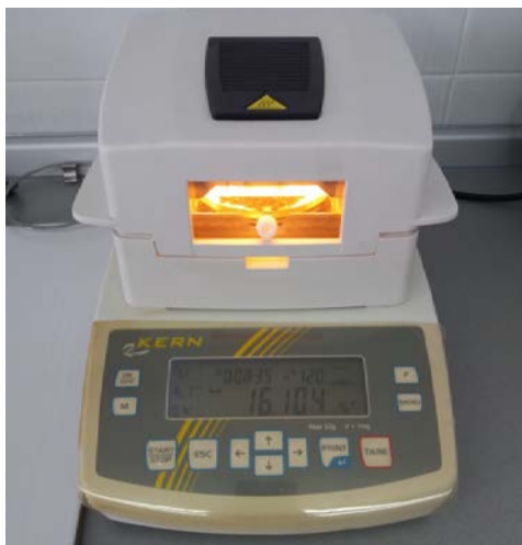
Слика 7. Мерење влаћности пелета органског ђубрива
