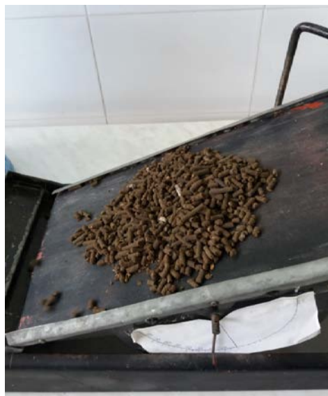
Слика 6. Коса равна за одређивање статичког угла трења
